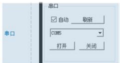
串口是上位机和设备通信的唯一途径，设备内置 HT42B53 USB 转串口芯片。
